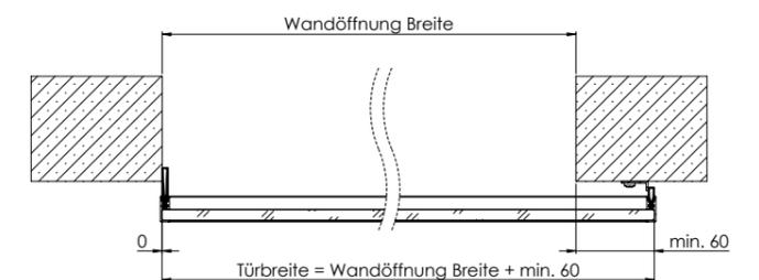
**HINWEIS** Technisch bedingt hat PLANEО AIR SILENT einen maximalen Abstand von 4,5 mm von der Wand. Abstandsets für z.B. Montage vor Sockelleisten sind separat erhältlich.
