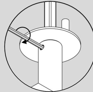
Nach durchbrechen der Wandung weiter drehen bis das Drehmoment erreicht ist / *After breaking through the wall turn further until the torque is reached*
