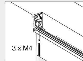
**Deckenbefestigung / ceiling mounting**
