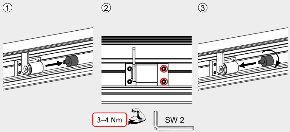
Der Softeinzug muss bis an den Endanschlag des Stoppers zurück geschoben werden / The soft-closing unit must be pushed back to the stop plate of the stopper.
