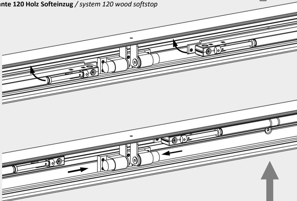
Der Softeinzug muss bis an den Endanschlag des Stoppers zurück geschoben werden / The soft-closing unit must be pushed back to the stop plate of the stopper.
