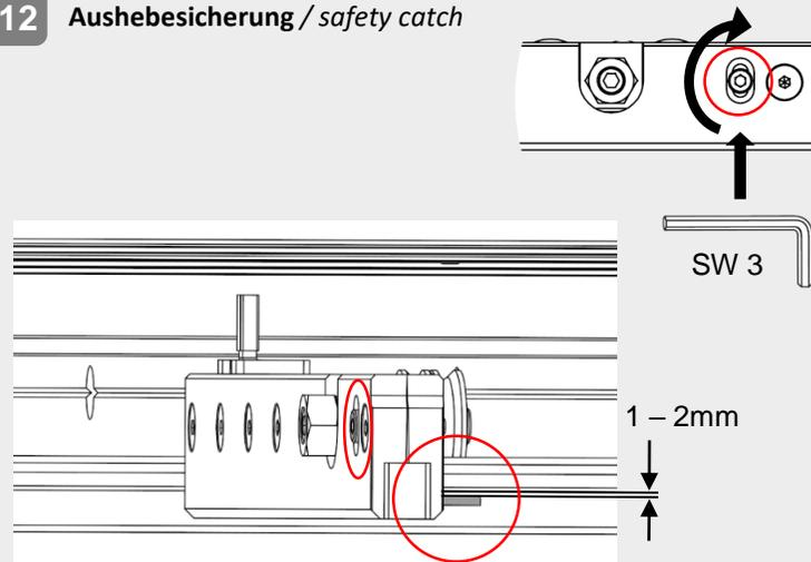
Abstand der Aushebesicherung zum Aluprofil auf 1-2mm einstellen und festziehen.
