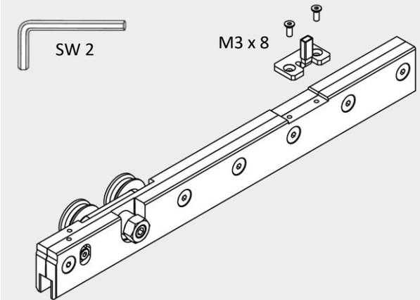
**!** 8mm Aktivator verwenden, 10mm Aktivator bei Holz nicht benötigt. / Use 8mm activator, 10mm activator not required for wood.
