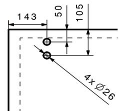
Glasbohrungen für Schiebtürbeschlag
