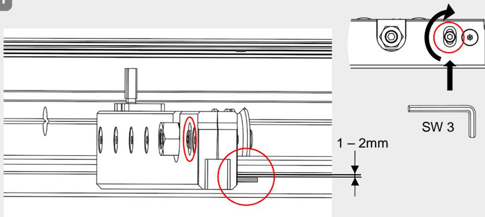
Abstand der Aushebelsicherung zum Aluprofil auf 1-2mm einstellen und festziehen.
